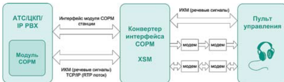
Рис. 2. Подключение конвертера к ПУ через модемы (аналоговый интерфейс)
