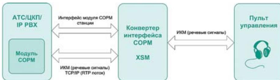
Рис. 1. Подключение конвертера к ПУ через тракт ИКМ
