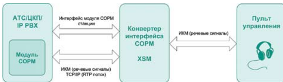
Рис. 1. Подключение конвертера к ПУ через тракт ИКМ
