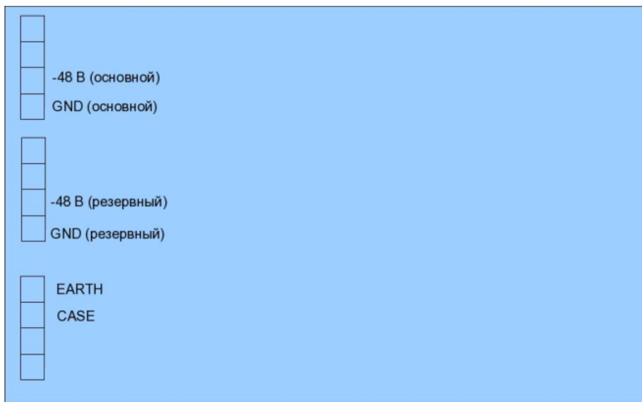
Рисунок. Расположение клемм для подключения питания и заземления (вид сзади)
